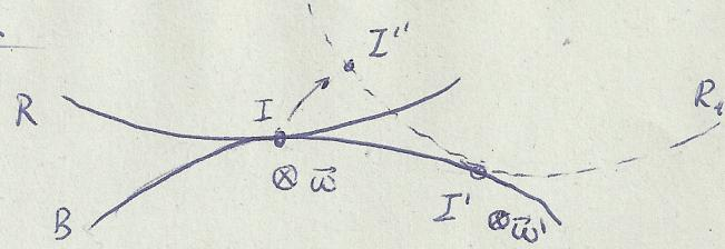
En el instante t, el Centro Instantáneo de Rotación es I, punto de tangencia de base y rueda en dicho instante, y la velocidad angular es  $\vec{\omega}$ .
